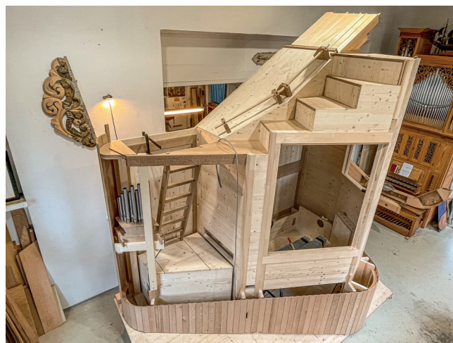
Das Gehäuse des Auxiliars im Bau in der Werkstatt.
